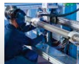
In der Filterfertigung setzt PACO Schweißanlagen aus eigenem Maschinenbau ein – zum Beispiel zur Produktion von überlangen Filterelementen (bis 4.200 mm).
