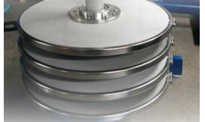
**Scheibenförmige Filterplatten kommen in der Horizontal-Platten-Druckfiltration (HPD) zum Einsatz. Da diese in immer mehr Industrien und Prozessen zum Einsatz kommt, steigt auch die Nachfrage nach PACO-Filterplatten und Regenerierungsservices.**
