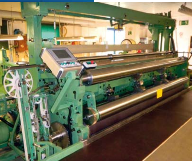
Die neue PACO-HD „Wide Loom“ 3000 fertigt im PACO-Werk Herolz bereits seit sechs Monaten störungsfrei und zuverlässig ihre Präzisionsmetalldrahtgewebe unterschiedlichster Spezifikation.
