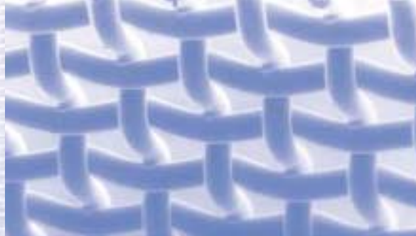
Die Siebgewebe der PACO DSS-Rahmen weisen webtechnisch nahezu identische Werte für die Kett- und die Schussrichtung auf als Voraussetzung für optimale Siebeigenschaften.
